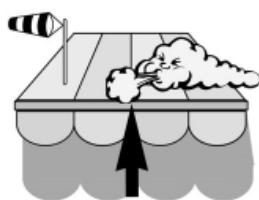
Если скорость ветра превышает установленное пороговое значение, электроприводу автоматически подаётся приоритетная команда на движение «Вверх». При этом команды на движение, поданные с запрограммированных радиопередатчиков блокируются на время, пока скорость ветра превышает установленное пороговое значение.
